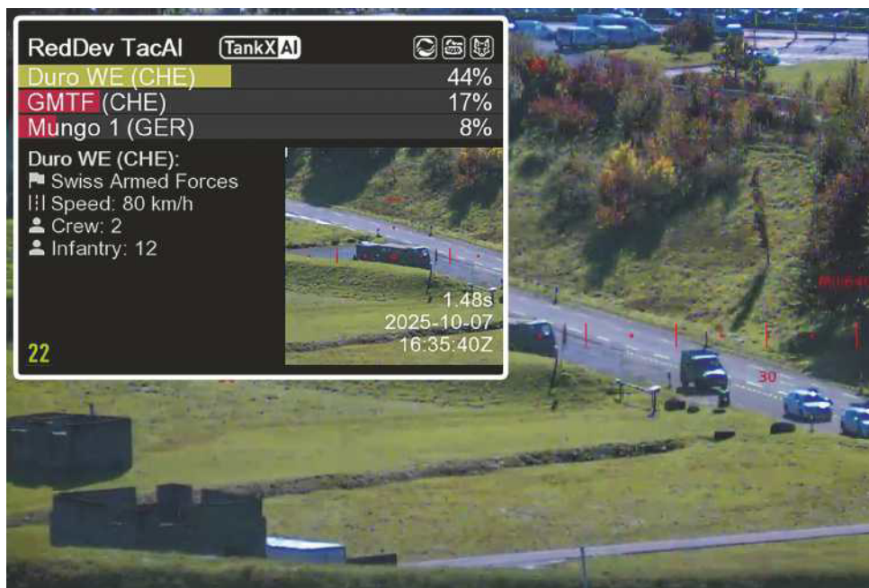
▲ Ein Gefechtsfahrzeug wird durch die TacAI-Apliance im Zielsystem Safran Vectronix Nightwolf erkannt und mit den wesentlichen Informationen dargestellt. Bild: Daniel Saxer
