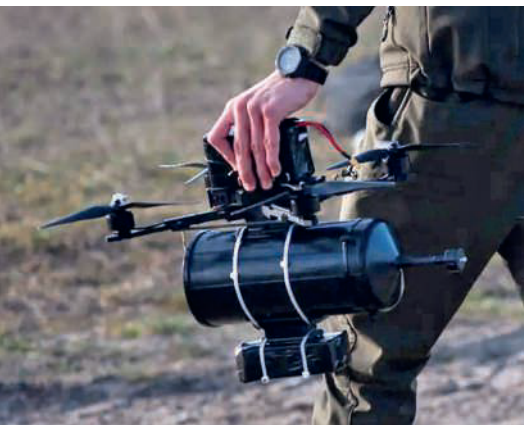
Trend Glasfaserkabel: Eine Fiber Optic Drone mit der markanten Kabelspuhle wird zum Start vorbereitet. Bild: io.wp.com
