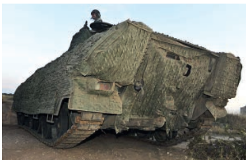
Beispiele von mobilen Tarnnetzen auf einem Raupenfahrzeug (SSZ) und Radfahrzeug (Saab). Bilder SSZ und Saab
