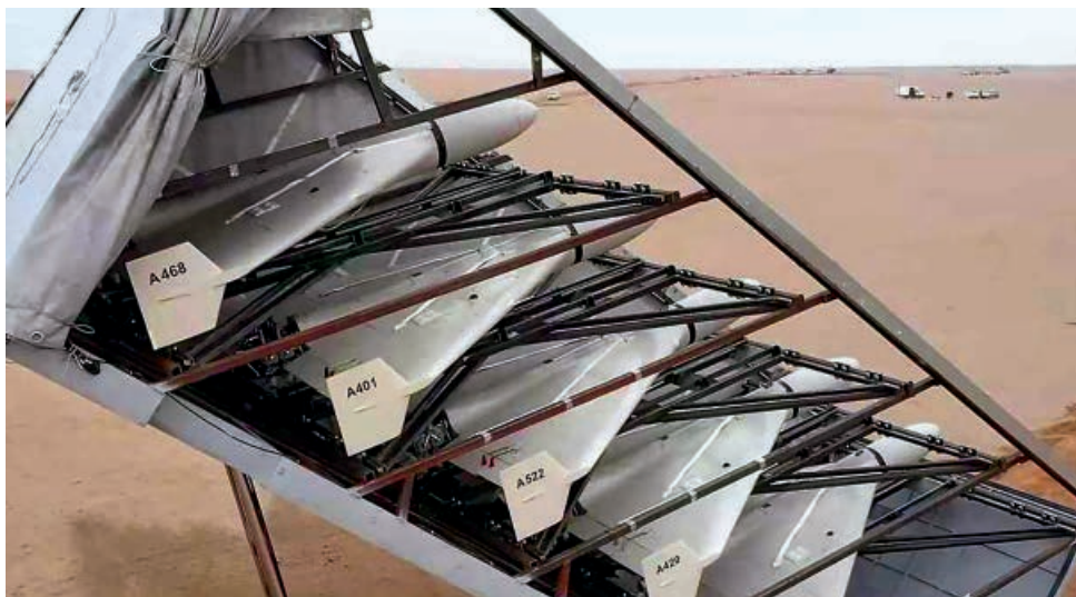
◀ Hohe Mobilität: Shahed-136 – in Russland Geran-2 genannt – lassen sich in Salven von fünf abfeuern, hier auf Basis eines Lastwagens. Geschätzte Reichweite bei 185 km/h: 2400 km. Bild: Twitter
