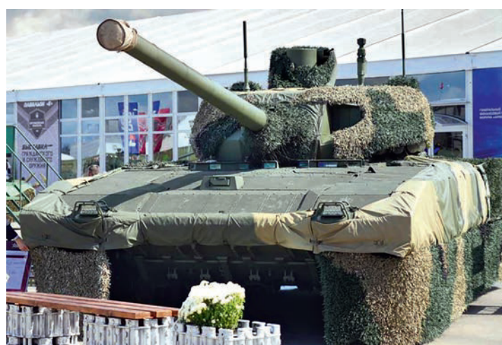
▶ Kampfpanzer T-14 mit mehrschichtigem Schutz- und Tarnsystem. Bild: RIA Novosti
